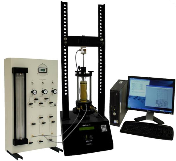
*Sistema Triaxial Standard Semi Automatizado con Panel de Control y Regulador de Presión Manual*
