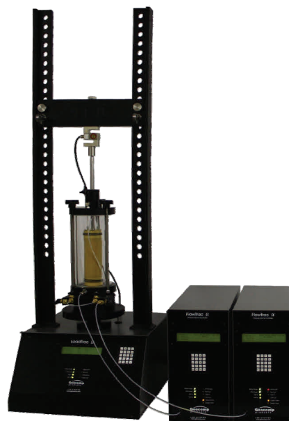
Sistema Standard Triaxial y de Trayectoria de Esfuerzos Completamente Automatizado
